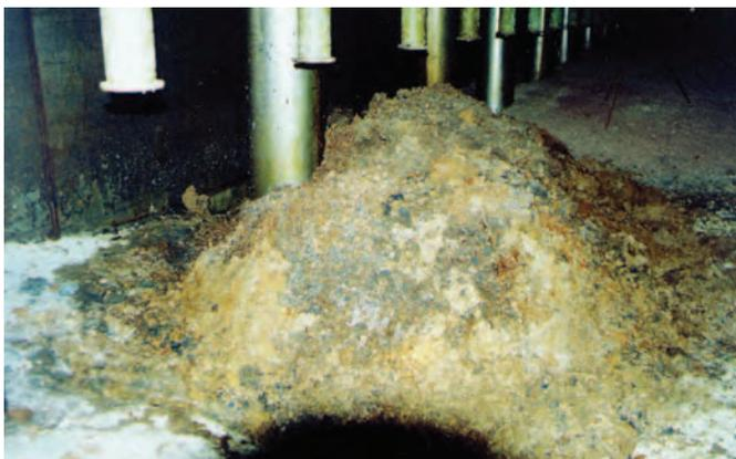
Bild 07: Brennstoffhaltige Materialien im Inneren des havarierten Blocks 4
